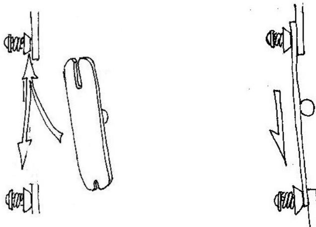
Zum verschliessen der Arbeitsöffnung, Abdecksieb in die Öffnung einführen. Die Seite mit der längeren Nut nach oben richten. Nut ganz nah bei der Innenseite unter die Klammer stecken und ganz nach oben drücken. Danach die kleinere Nut unter die untere Verklammerung stecken und nach unten ziehen bis das Abdecksieb fest vergeklemmt ist.
